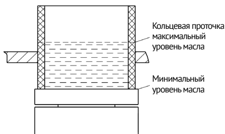
Рис. 7. Уровень залива масла в стакан.
